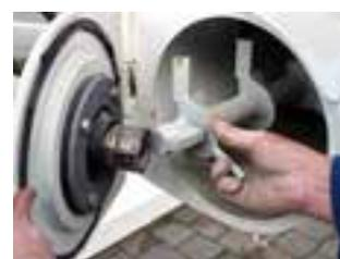
**3** Replacer l'axe de transport avec un accouplement propre et refermer la chambre sèche.
