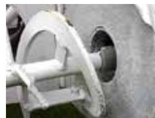
**7** Nettoyer et accoupler correctement les axes de transport et de malaxage. (Garder la connection propre - ne pas graisser l'accouplement).
