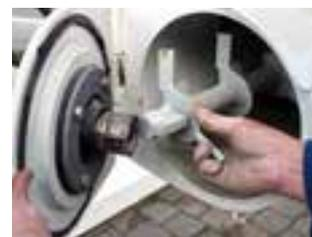
**3** Replacer l'axe de transport dans un accouplement propre et refermer la chambre sèche.
